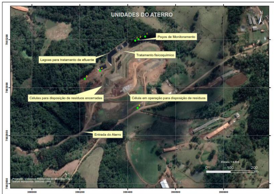
Figura 11: Disposição das estruturas no Aterro Sanitário.
