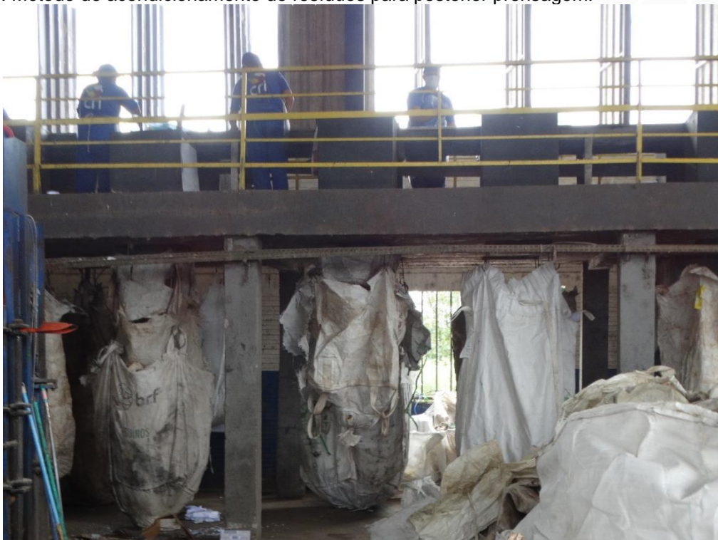
Figura 5: Método de acondicionamento de resíduos para posterior prensagem.
